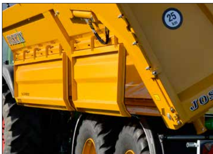
Een plaat beschermt de wielen bij het lossen aan de zijde
