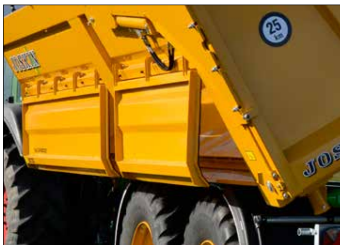
Una chapa protege las ruedas durante el descargamiento lateral
