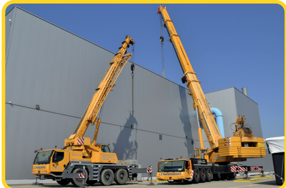
Grues en action pour le remplacement de la cuve
