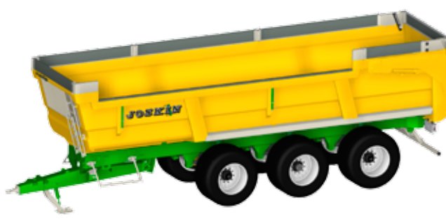
Trans-SPACE 9200 mit starren Bordwanderhöhen von 25 cm
