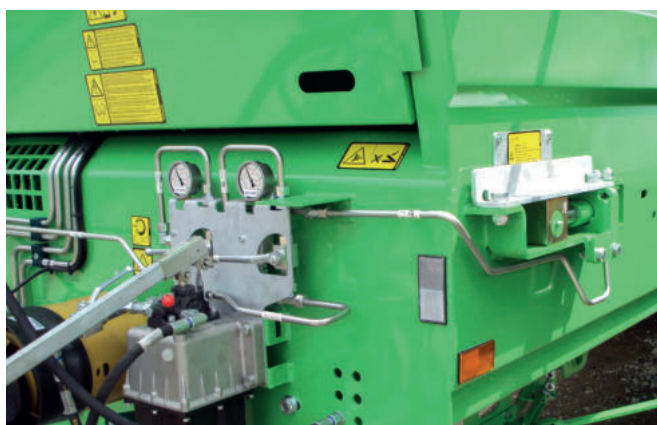
Tensores de cinta hidráulicos sobre bomba manual
