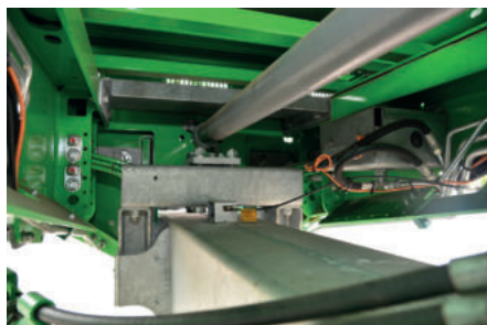
Sistema de pesaje con balanzas (modelos simple eje)
