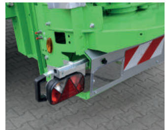
Luces de señalización LED completas, retráctiles
