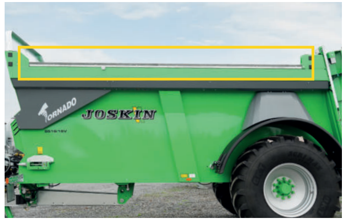
Protección PVC del borde superior
