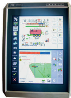
Gestión de las funciones hidráulicas del esparcidor mediante Load Sensing o ISOBUS
