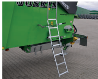
Escalera de acceso galvanizada
