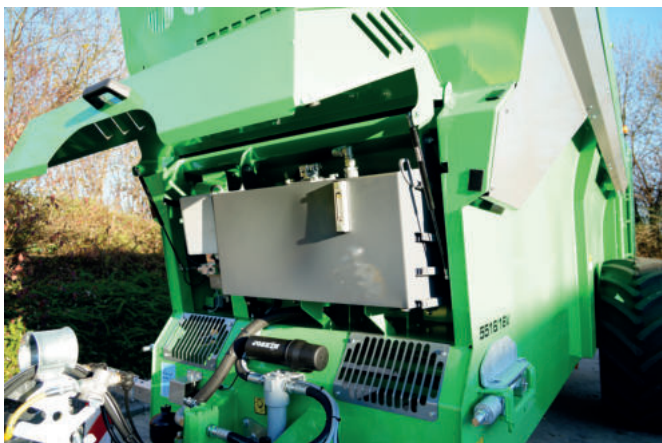
Central hidráulica (útil cuando hay que acoplar el esparcidor a varios tractores para evitar que se mezclen los aceites)
