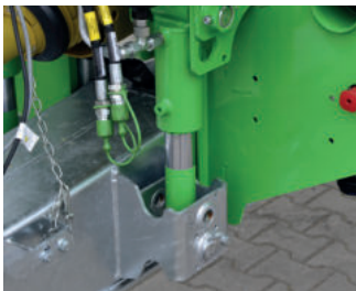
Suspensión hidráulica simplificada de la lanza con circuito cerrado
