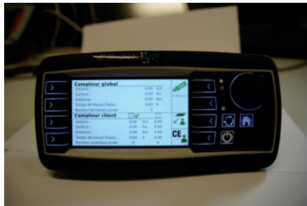
Diferentes pantallas de visualización y cajas de mando están disponibles: Ferti-control 500, 4000 (de serie sólo en Horizon), Touch 800...
