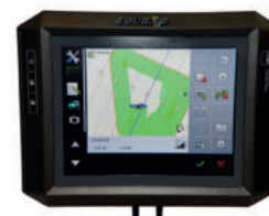
Gestión de las funciones hidráulicas del esparcidor mediante Load Sensing o ISOBUS
