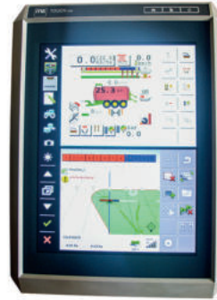
Bedienung der hydraulischen Funktionen des Stallungstreuers über Load Sensing oder ISOBUS
