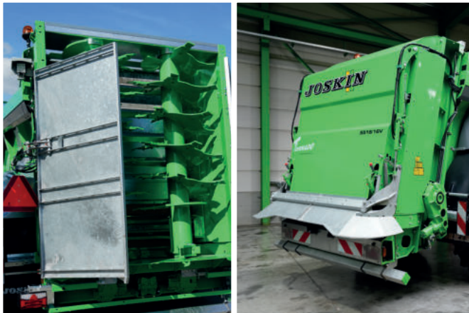
Randstreuklappen, um das Streuen auf Straßen oder Flüsse am Feldrand zu verhindern
