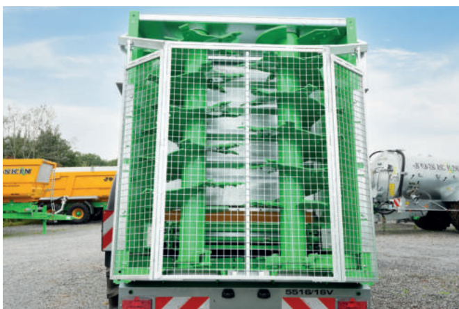
Schutzgitter der Fräswalzen mit hydraulischer Öffnung für Straßenfahrten (nur auf „vertikale“ Modelle verfügbar)
