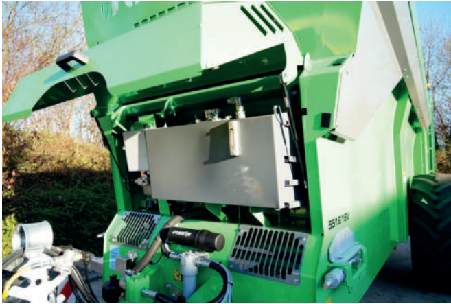
Hydraulikzentrale (nützlich, wenn der Streuer an mehrere Traktoren angehängt werden muss, um ein Vermischen der Öle zu vermeiden)
