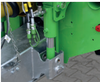
Hydraulische Deichselfederung im geschlossenem Kreislauf
