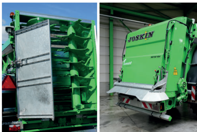
Volets de bordure pour éviter les projections d'effluents sur les routes ou rivières en bordure de champs
