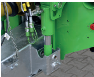
Suspension hydraulique simplifiée à circuit fermé du timon
