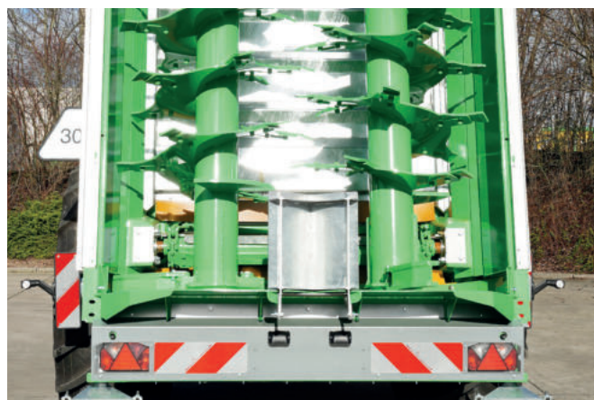
Séparateur arrière central galvanisé (uniquement disponible sur les modèles « verticaux »)
