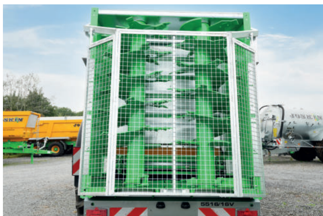
Grille de protection des hérissons à ouverture hydraulique pour déplacement sur route (uniquement disponible sur les modèles « verticaux »)
