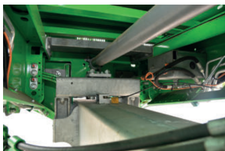
Système de pesage avec pesons (modèles simple essieu)
