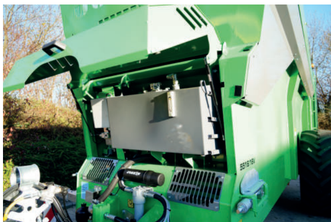
Centrale hydraulique (utile quand l'épandeur doit être attelé à plusieurs tracteurs pour éviter de mélanger les huiles)
