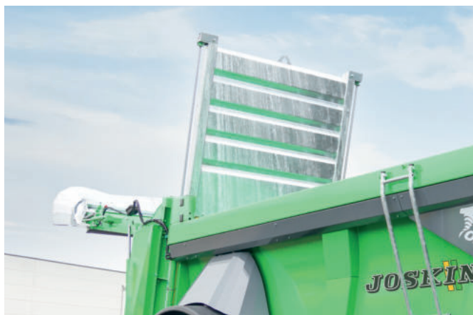
Porte « guillotine » galvanisée pour faciliter le dosage ainsi que pour le transport de matières plus fluides (en standard sur les modèles « HORIZON »)
