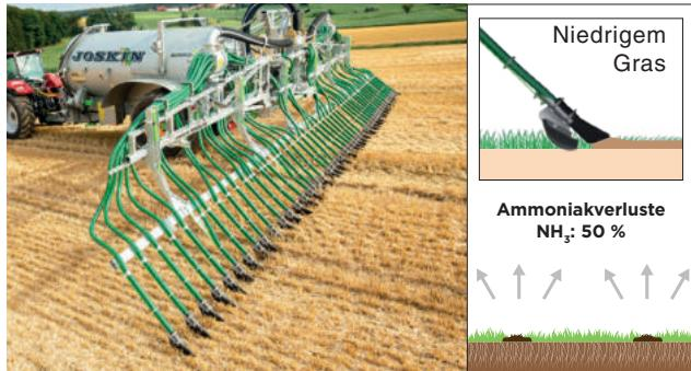
abgelegt werden können, ohne die Grasblätter zu beschmutzen, oder ohne im Futter zu gelangen. Diese Geräte sind daher ideal für die Düngung von Grünland. Auch hier verbleibt die Gülle zwar an der Oberfläche, sorgt aber durch den permanenten Kontakt mit dem Boden eine noch stärkere Reduzierung der Grasverschmutzung und der Verluste von flüchtigen Nährstoffen um ca. 50 %.
