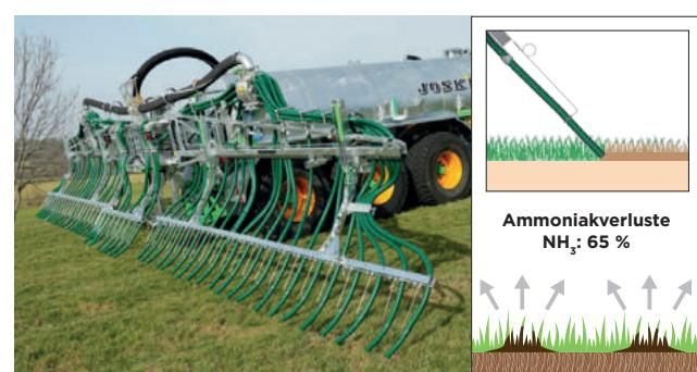
Neben diesen Modellen finden wir die sogenannten **Gestänge mit „Schleppschuhen“**. Sie basieren auf einen ähnlichen Aufbau, sind aber zusätzlich mit Kufen ausgestattet, die dank eines gefederten Flügelsystems einen konstanten Bodendruck ausüben. Durch den Druck der Schleppschuhe wird der Pflanzenbestand geöffnet, damit die Nährstoffe präzise, und so nah wie möglich an der Basis
