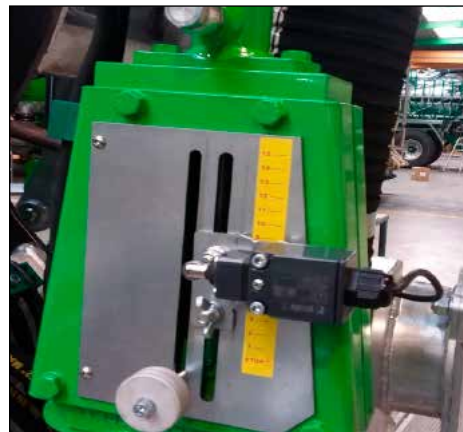
Industrieller Schieber RAMUS mit Öffnungseinstellung
