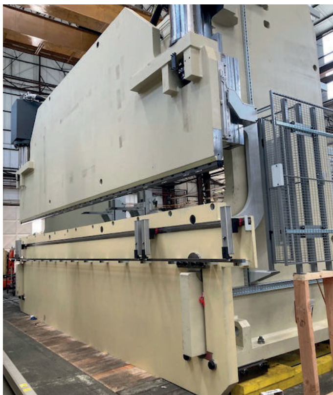
Nowa prasa krawędziowa w trakcie montażu u dostawcy (po lewej) i przyszłe miejsce jej instalacji w fabryce (po prawej)
