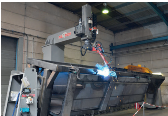
Monocoque laadbak van een kipwagen bevestigd op een roterende mal en gelast door een robot
