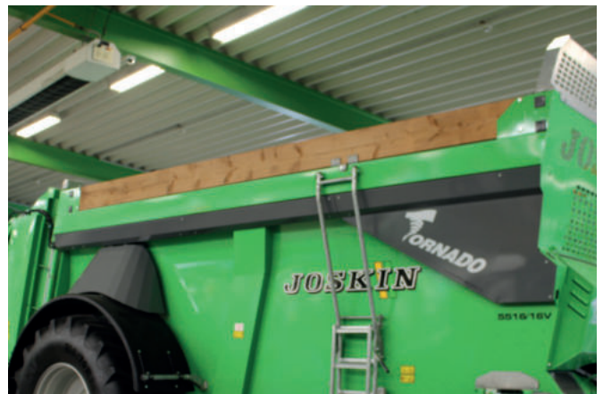
Houten of aluminium opzetschotten (250 mm) om het laadvermogen te vergroten
