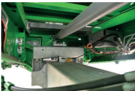
Weegstelsel met weegcellen (enkelassige modellen)
