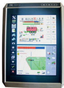
Bediening van de hydraulische functies van de strooier via Load Sensing of ISOBUS
