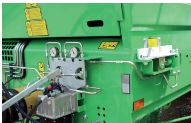
Hydraulische bodemkettingspanners op handpomp
