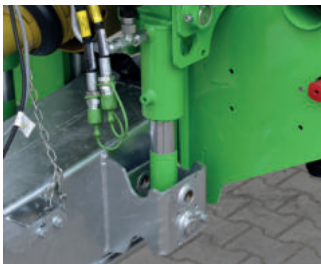
Vereenvoudigde hydraulische disselvering met gesloten circuit
