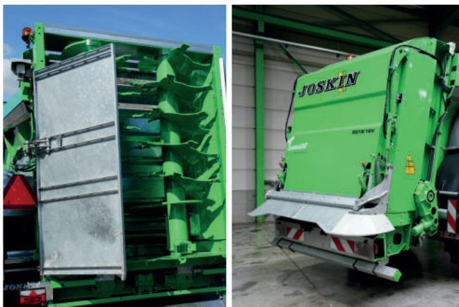
Randluiken om te voorkomen dat stalmest op wegen of in rivieren aan de rand van velden terechtkomt
