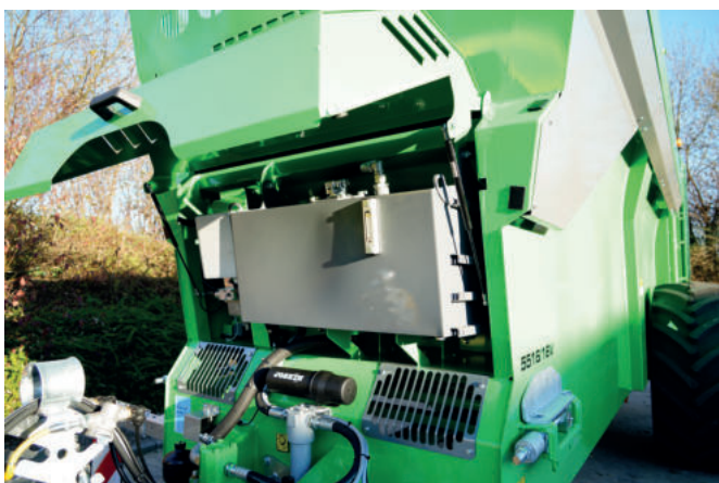
Hydraulische installatie (nuttig wanneer de strooier aan verschillende trekkers moet worden gekoppeld om de vermenging van de oliën te voorkomen)
