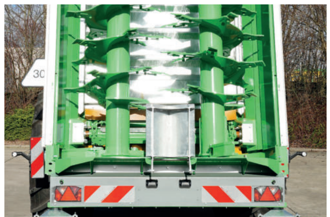
Gegalvaniseerde centrale afscheiding aan de achterzijde (alleen beschikbaar op "verticale" modellen)
