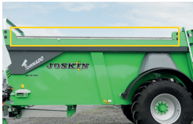
PVC bescherming van de bovenrand
