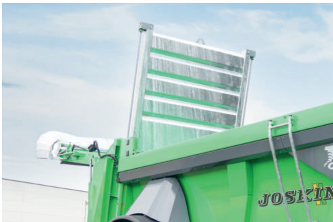
Gegalvaniseerde doseerschuif voor een eenvoudige dosering en het transport van lichtere materialen (standaard op "HORIZON"-modellen)
