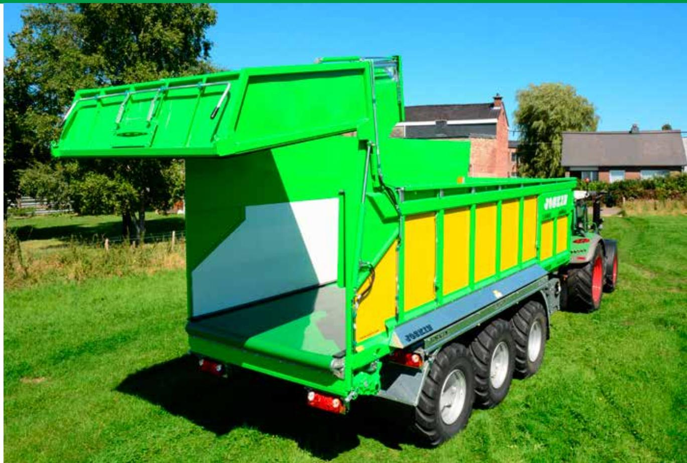
Особенностью Drakkar является высокопрочный донный транспортер, который наматывается на вал в задней части транспортного средства. Вместе с транспортером перемещается мобильная передняя стенка, обеспечивающая выгрузку без сжатия перевозимого продукта.
