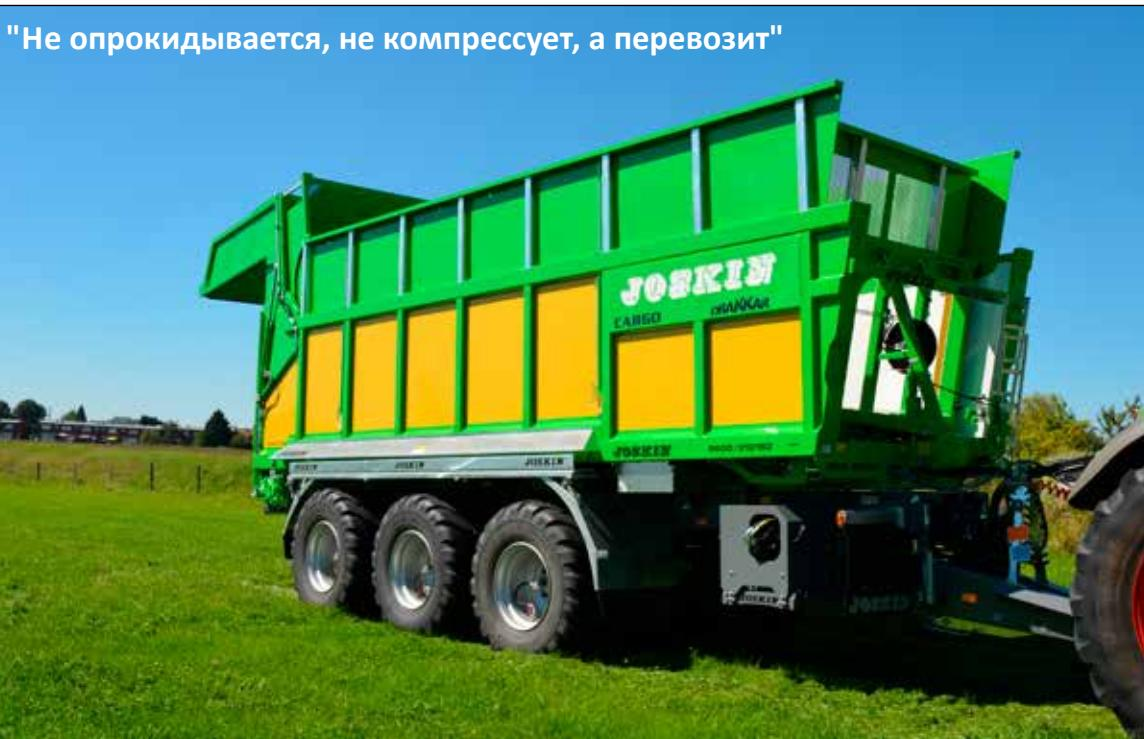
Линейка универсальных прицепов Drakkar встретила настоящий успех, в частности, благодаря высоте кузова 150 мм. Эти более низкие модели были разработаны, чтобы снизить высоту загрузки (при уборке картофеля, корнеплодов и т.д.). При этом объем кузова уменьшается.
