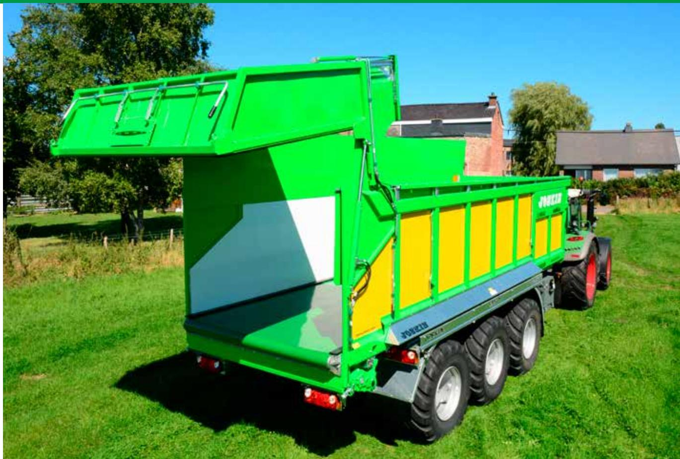
La particularidad del Drakkar es su suelo con alta resistencia montado sobre el suelo de la máquina que se enrolla en la parte trasera del vehículo. La pared frontal acompaña este movimiento lo que permite asegurar la descarga completa sin compresión de la materia transportada.
