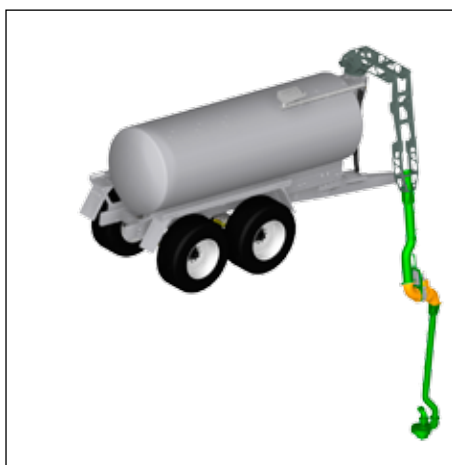
Насосная стрела с погружным турбоагнетателем
