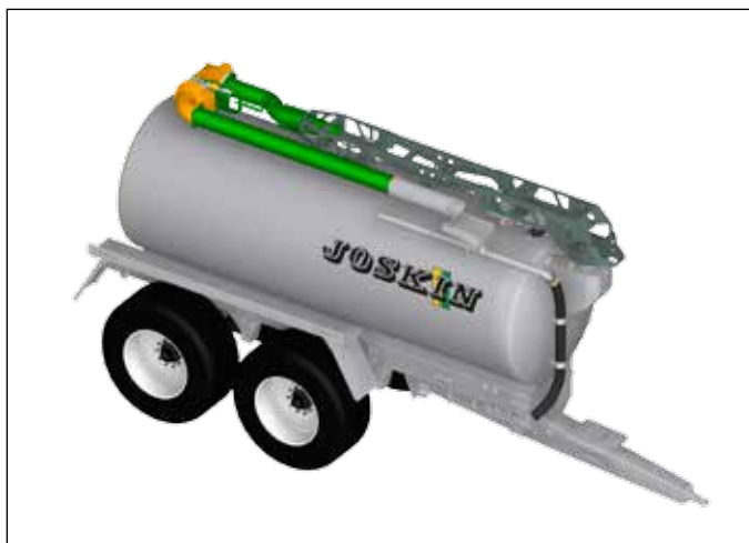
Верхняя стрела, установленная на переднюю муфту, в сложенной позиции
