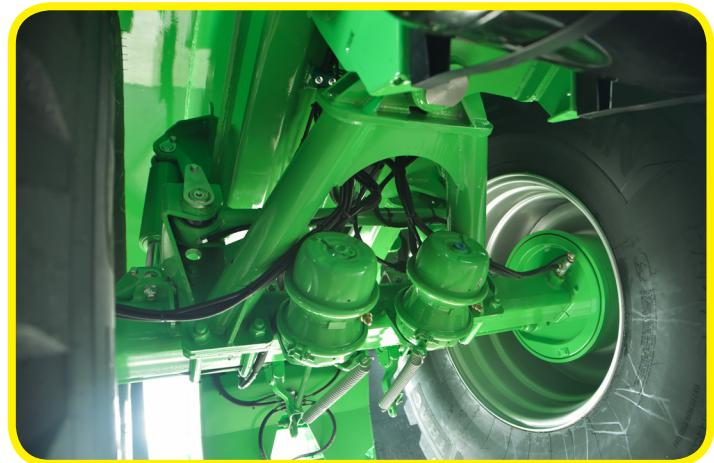
eine gelenkige Dreiecksstruktur verbunden. Wie bereits mit Erfolg auf den Tiefbaukippern verwendet, erlaubt diese Federung eine bessere Geländeangepassung ganz gleich wie die Topographie ist und zeichnet sich weiterhin durch hohe Wartungsfreundlichkeit aus (Abschmieren etc.).
