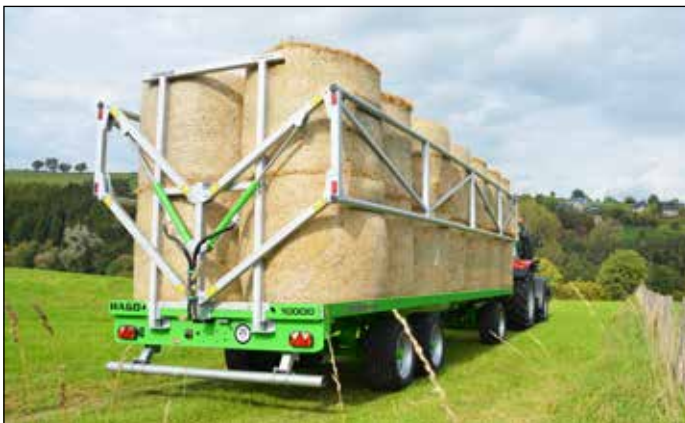
An- und Abhebevorgang mittels hydraulischen Zylinders
