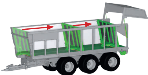
Bewegende voorwand getrokken door de afvoerband naar de achterkant van de machine
