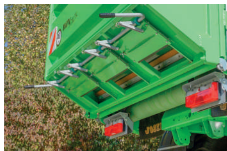
Goederen lossen via de graanschuiven
