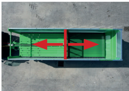
Bewegende voorwand getrokken door de afvoerband naar de achterkant van de machine
