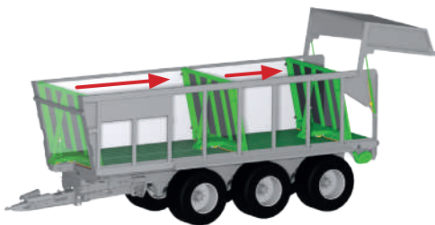
Pared frontal móvil arrastrada por la cinta hasta la parte trasera de la máquina
