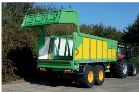
Hecktür mit großem Öffnungswinkel
