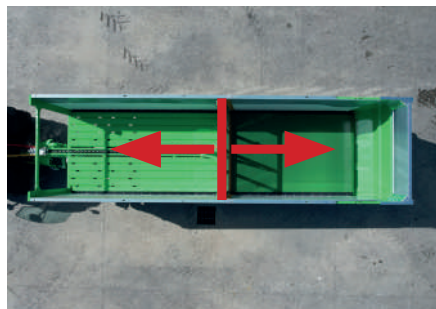
Paroi frontale mobile tirée par le tapis vers l'arrière de la machine
