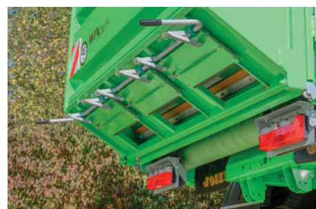
Déchargement de la marchandise par les trappes à grains
