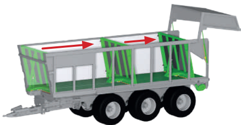
Ruchoma ścianka przednia ciągnięta przez taśmę do tyłu maszyny
