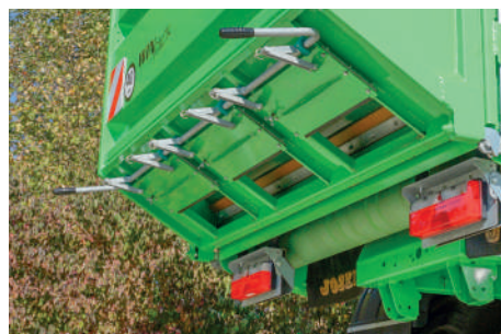
Wyładunek materiału przez spusty zbożowe
