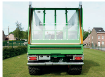
Przezroczysta ścianka przednia zapewniająca lepszą widoczność z kabiny
