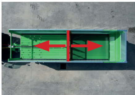
Ruchoma ścianka przednia ciągnięta przez taśmę do tyłu maszyny
