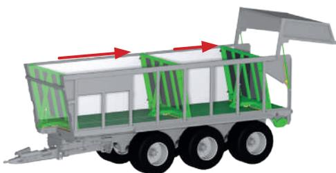
Передняя мобильная стенка, тянущаяся транспортером в заднюю часть прицепа
