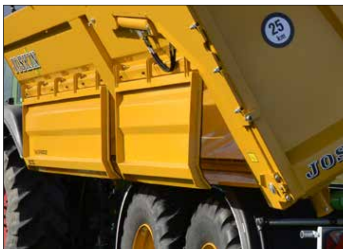
Un tôle protège les roues lors du déchargement latéral
