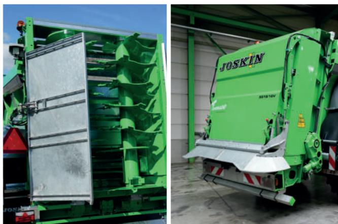
Бордюрные створки ограничивают разбрасывание, предотвращая попадание навоза на дорогу, в водоем или при внесении на крае поля
