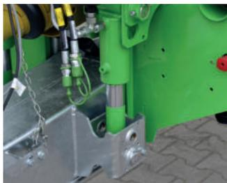
Упрощенная гидравлическая подвеска дышла (закрытая система)
