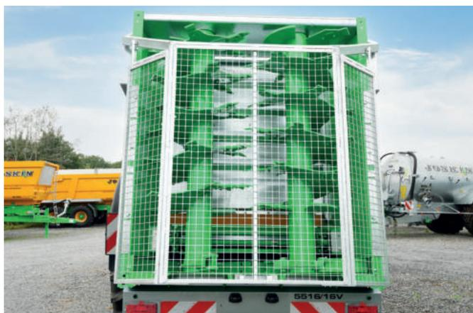
Защитная решетка разбрасывающего механизма с гидравлическим открытием для движения по дороге (только для вертикальных моделей)
