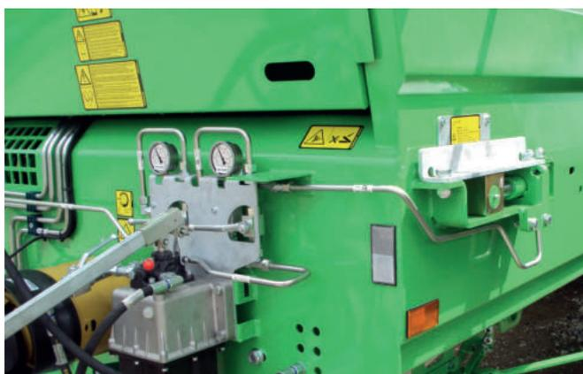
Гидравлические натяжные устройства транспортера на ручном насосе
