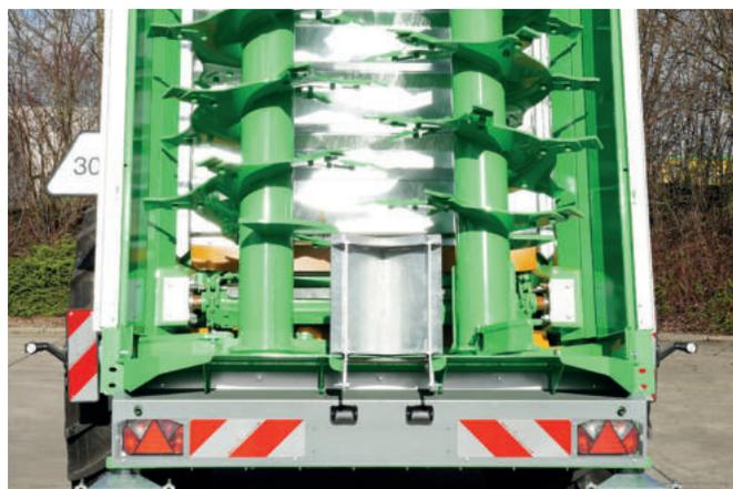
Задний центральный оцинкованный сепаратор (только для вертикальных моделей)
