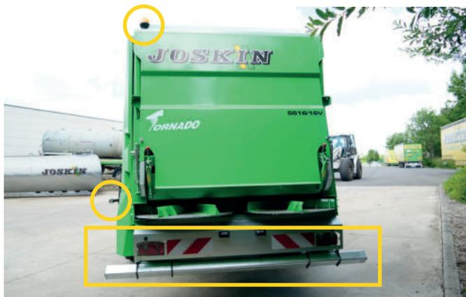
Заднее защитное устройство, дополнительные световые приборы (проблесковый маячок, фары)
