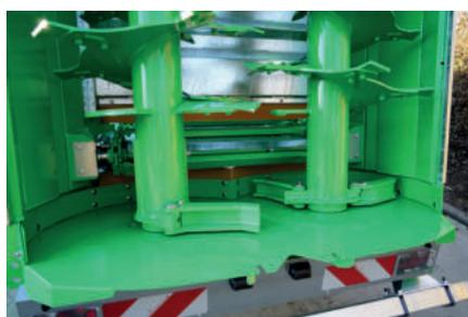
*Откидные лопатки (Ø 1.060 мм)*
