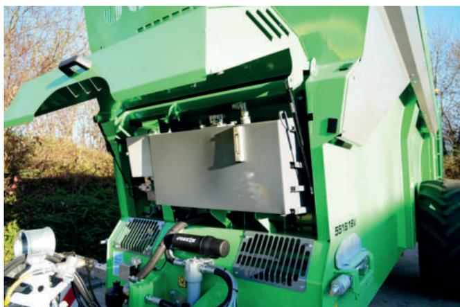
Гидравлическая установка (практична при агрегатировании с разными тракторами, чтобы не смешивать масло)
