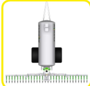
задний люк цистерны Ø 600 мм путем фиксации двух кронштейнов на уголки цистерны. Благодаря этому, 2 новые модели могут агрегатироваться как с новыми, так и со старыми цистернами без необходимости монтажа специального оборудования. Кроме того, они совместимы с моделями ALPINA2 и MODULO2, диаметр колес которых не превышает 1.820 мм. Штанги также могут быть установлены на подъемник.
