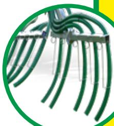
**Штанга Penditwist Basic.** Имеет повышенные агрономический интерес, так как жижа, поступающая по трубкам, вносится непосредственно у корней растений, не замедляя их рост. Таким образом, контакт между нитратами, содержащимися в навозной жиже, и воздухом значительно снижен. Благодаря таким характеристикам, эта штанга особенно эффективна для обработки культур.
