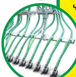
**Что касается штанги Pendislide Basic,** то она больше подходит к внесению жижи на луга. Штанга оснащена износостойчивыми сошниками из эрталона, оказывающими постоянное давление на почву благодаря системе подпружиненных пластин. Раздвигая растительность, сошники обеспечивают точное попадание жидкого навоза к корням, не забрызгивая при этом растения.
