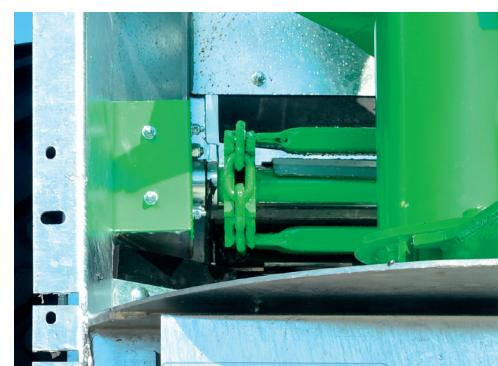
Откидные лопатки были существенно удлинены. Благодаря своей подвижной концепции, они не вступают в контакт в посторонними предметами. Удлиненные лопатки повышают качество разбрасывания и измельчают продукт. Соответственно, объем разбросанного и измельченного продукта увеличивается.
