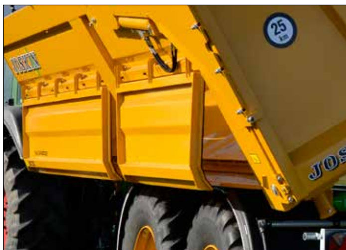
Щиток, защищающий колеса при выгрузке
