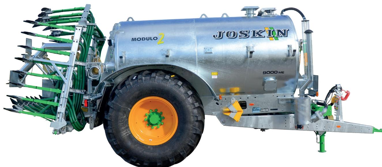
Что касается доступных насосных систем, то каждый найдет, что ему нужно среди пяти предлагаемых вариантов. Классическая боковая заслонка, верхний герметичный гидравлический люк, насосный рукав со сменой стороны закачивания, для работы которого достаточно одного гидровыхода, боковой рукав на шарнире и верхняя насосная стрела. Ко всем этим системам может быть добавлен акселератор закачивания в форме турбоагнетателя с гидравлическим мотором.
