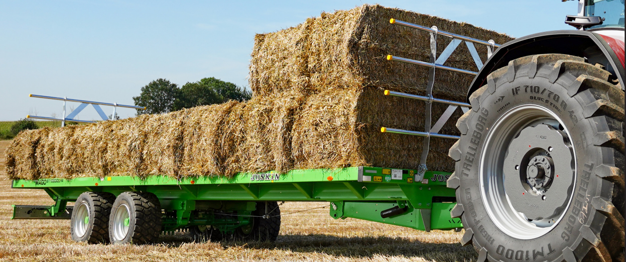
Podłoga z blachy giętej ocynkowanej lub karbowanej pomalowanej
