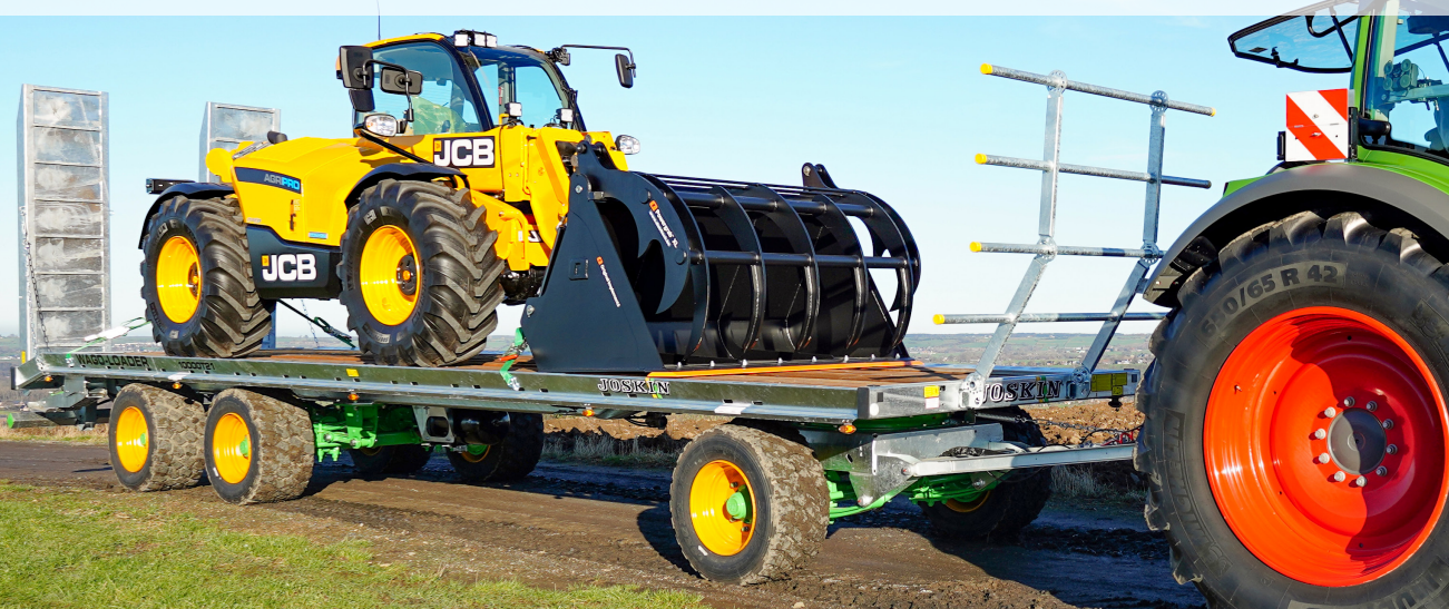
Наклонный удлинитель на всех самонесущих моделях с гидравлическими или ручными рампами
