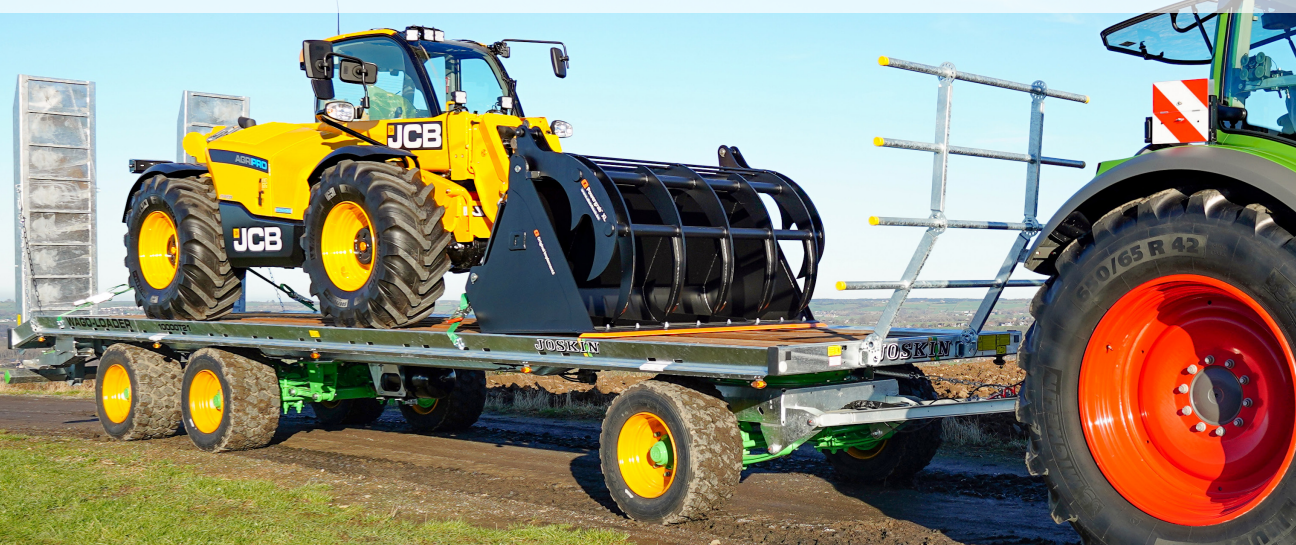
Schuin verlengstuk op de getrokken modellen met hydraulische of handbediende oprijplaten
