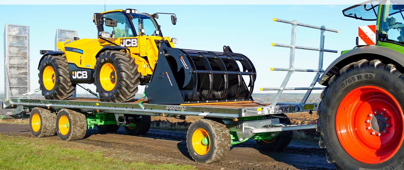
Geneigte Verlängerung bei gezogenen Modellen mit hydraulischen oder manuellen Rampen
