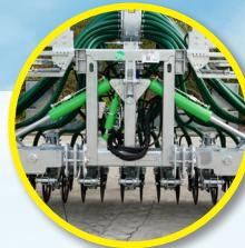
Bastidor totalmente galvanizado con sistema pendular
