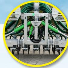
Châssis entièrement galvanisé avec système pendulaire
