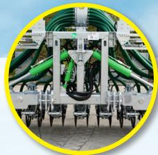
Bastidor totalmente galvanizado con sistema pendular
