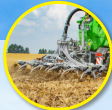
TERRAFLEX/3 Ширина захвата: от 4,4 до 6 м
