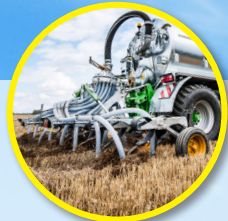
TERRAFLEX/2 Ширина захвата: от 2,7 до 5,2 м
