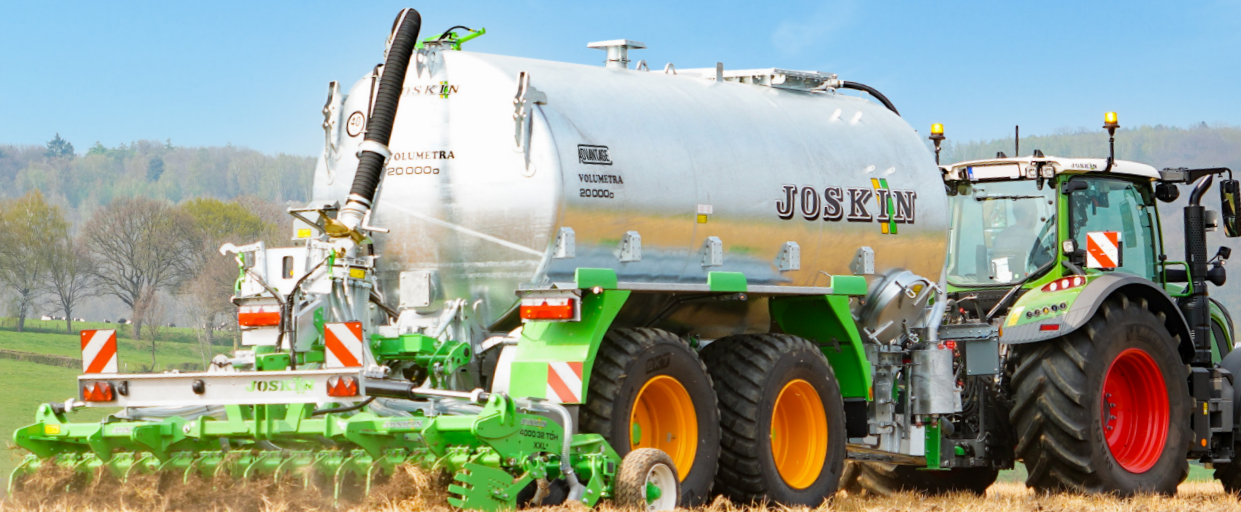
TERRAFLEX/2 Ширина захвата: от 2,7 до 5,2 м
