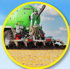
TERRASOC Szerokość robocza: od 2,8 do 5,2 m
