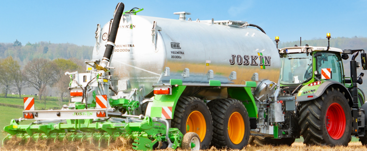
TERRAFLEX/2 Szerokość robocza: od 2,7 do 5,2 m
