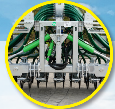
Volledig galvaniseerd frame met pendelsysteem
