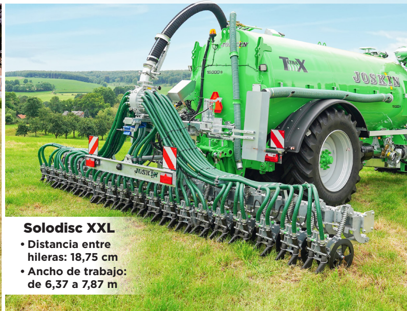
Bastidor totalmente galvanizado con sistema pendular
