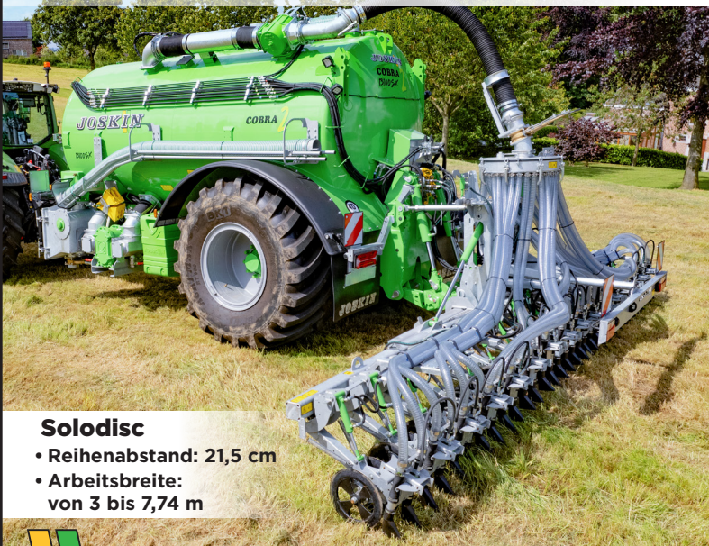
Selbstschärfende Scheiben von 400 x 20 mm auf Naben mit „lebenslanger Schmierung“
