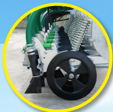
Tropfstopp-Klemmbacken mit hydraulischem Verschluss
