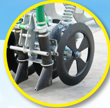
Zelfslijpende schijven (400 x 20 mm) op "levenslang gesmeerde" navens
