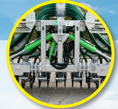
Volledig gegalvaniseerd frame met pendelsysteem
