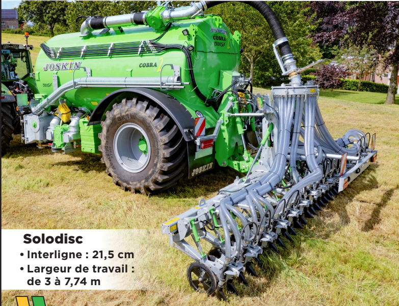
Disques auto-affûtants de 400 x 20 mm sur moyeux avec « graissage à vie »
