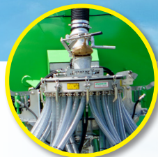
Repartidor-triturador Scalper excéntrico horizontal (Solodisc) o vertical (Solodisc XXL)
