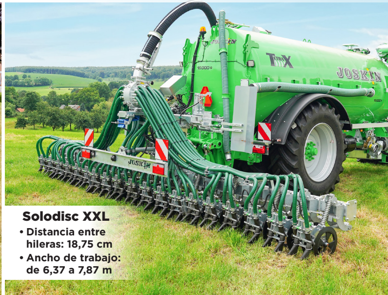
Repartidor-triturador Scalper excéntrico horizontal (Solodisc) o vertical (Solodisc XXL)
