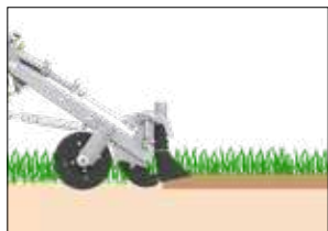
Inyector con patines cónicos y discos cortantes
