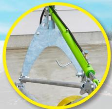
Cilindro simple efecto para ajustar el ángulo de inclinación hasta 45°
