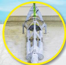
Estructura triangular garantizando una estabilidad óptima e impidiendo cualquier torsión del eje de transmisión
