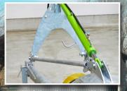
Vérin simple effet permettant de régler l'angle d'inclinaison jusqu'à 45°
