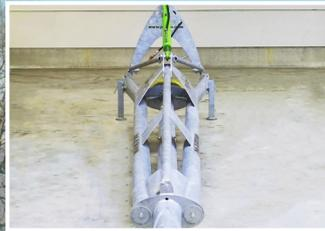
**Estructura triangular garantizando una estabilidad óptima e impidiendo cualquier torsión del eje de transmisión**
