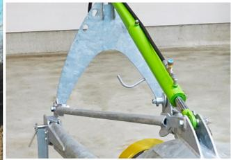
**Cilindro simple efecto para ajustar el ángulo de inclinación hasta 45°**
