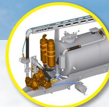
Pompe à vide industrielle de 18 000 l/min • Pompe à haute pression de 120 l/min à 120 bars
