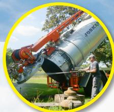
Cuve basculante avec fond intégral à ouverture hydraulique
