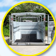
Système « ras-du-sol » 17 cm et portes arrière à ouverture totale
