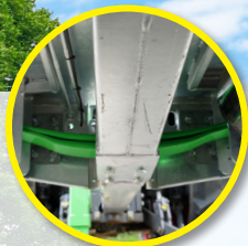
Suspension du timon par lames transversales
